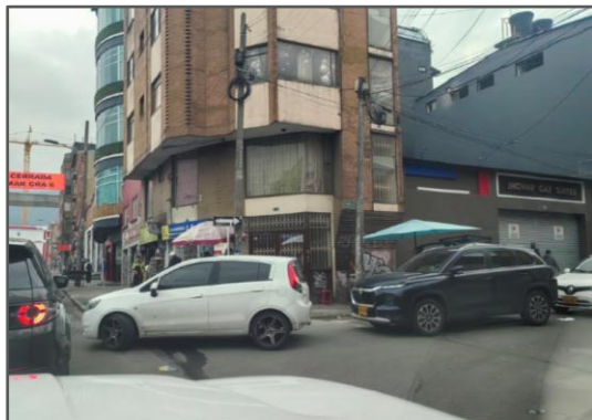
Figura 66. Tramo de la Av. Calle 63 con problemática de contravías y estacionamiento en vía asociado a actividad comercial, lo que reduce el ancho efectivo de calzada, genera fricción lateral y afecta la continuidad del flujo vehicular.
