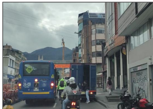
Figura 66. Tramo de la Av. Calle 63 con problemática de contravías y estacionamiento en vía asociado a actividad comercial, lo que reduce el ancho efectivo de calzada, genera fricción lateral y afecta la continuidad del flujo vehicular.
