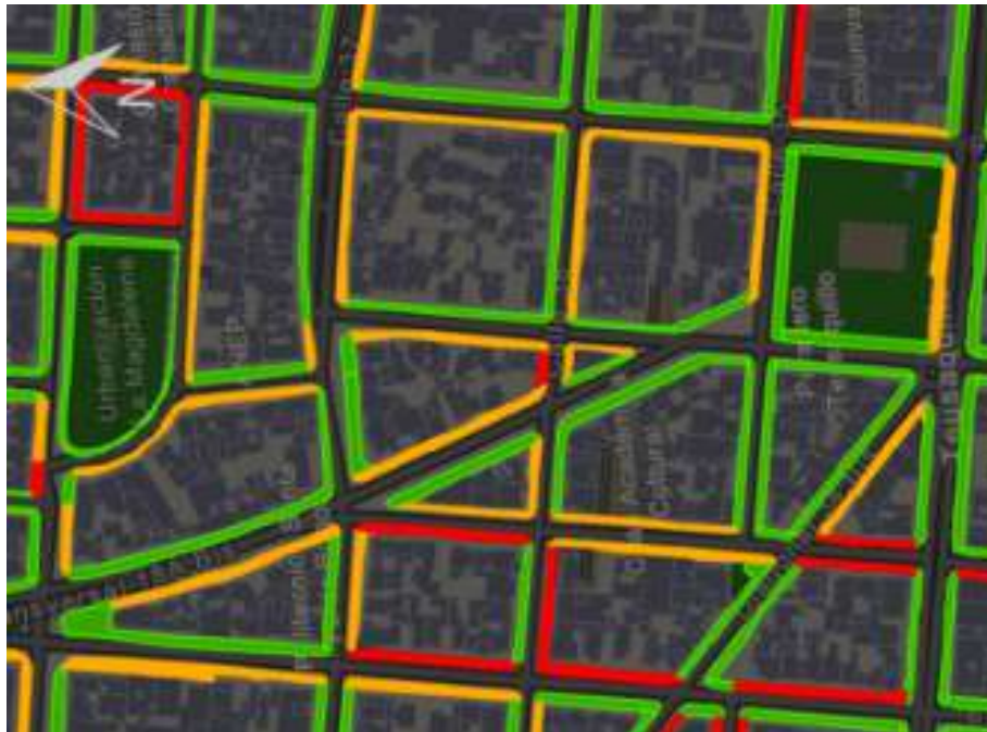
Imagen 20. Estado de la infraestructura Peatonal Polígono BV
