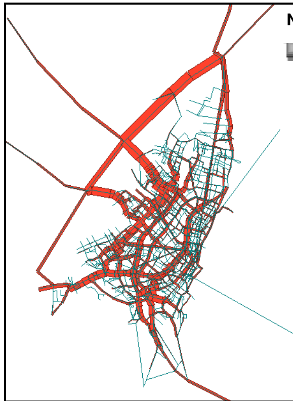
Figura 7-6. Precarga total de camiones y motos en vehículos equivalentes
